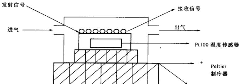
图 1 露点仪测量原理示意图
